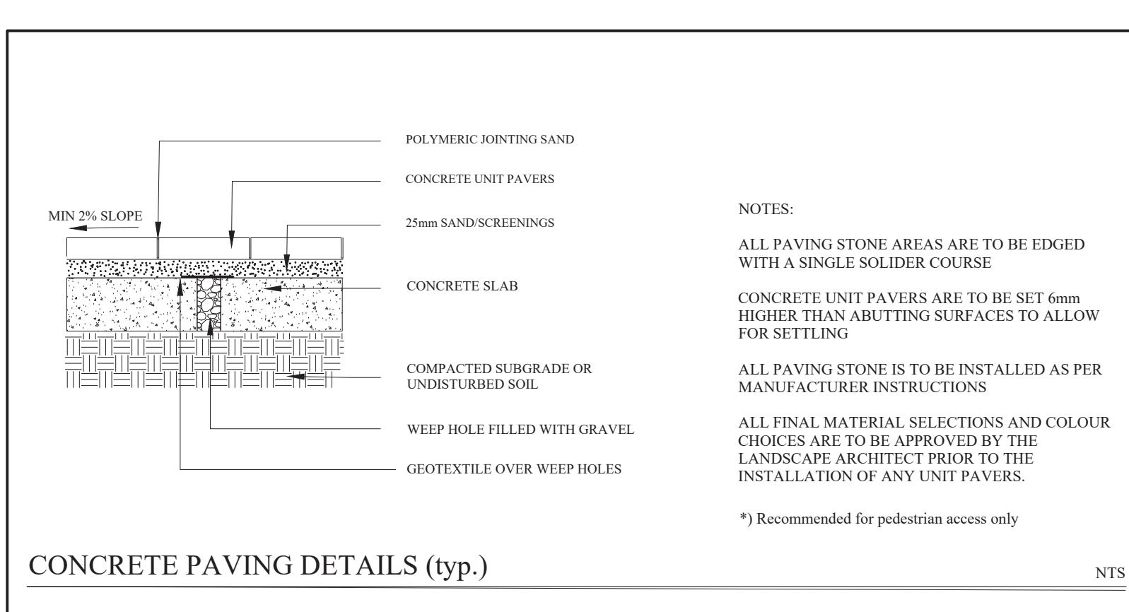
CONCRETE PAVING DETAILS (typ.)
