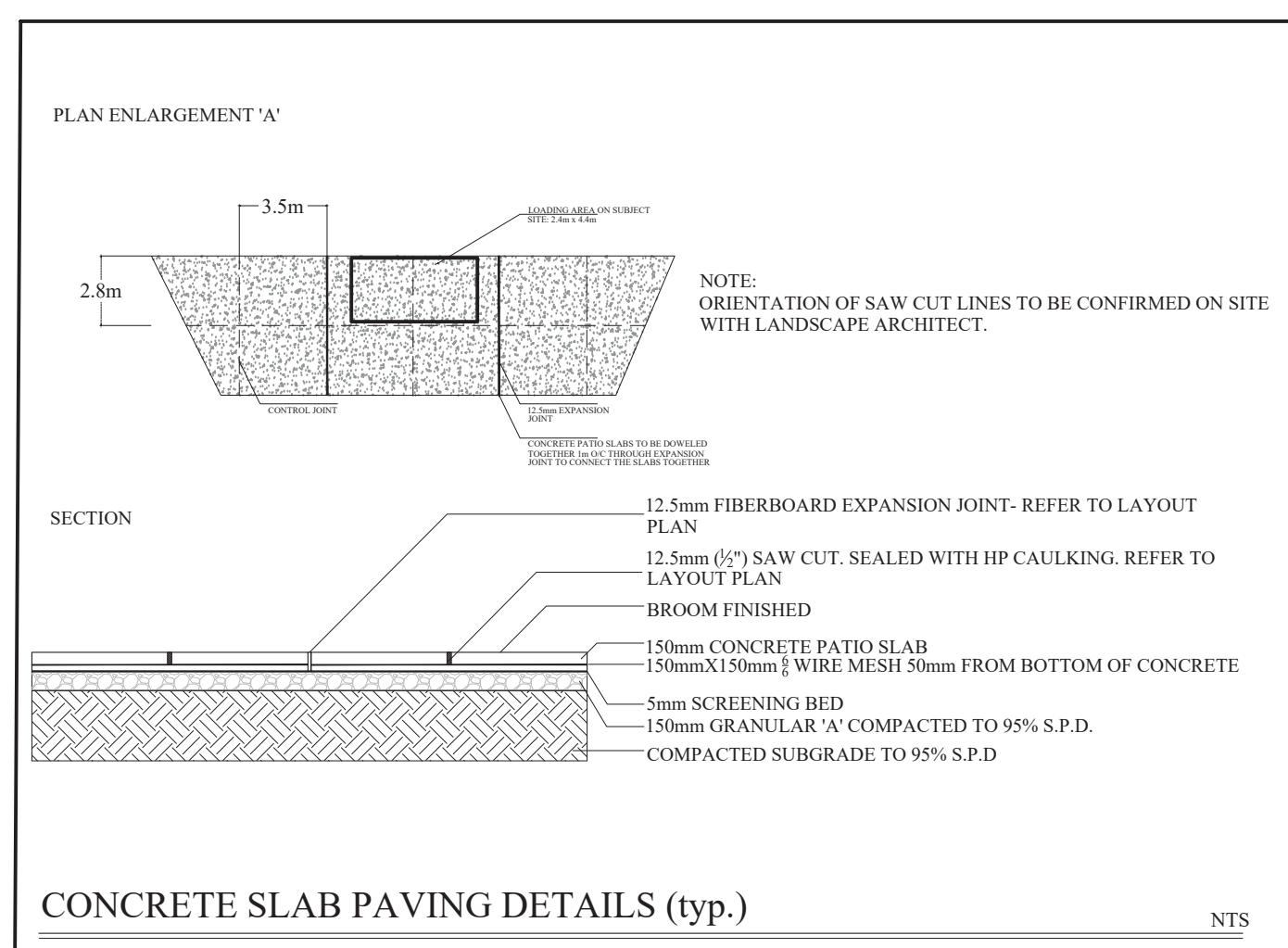
CONCRETE SLAB PAVING DETAILS (typ.)
